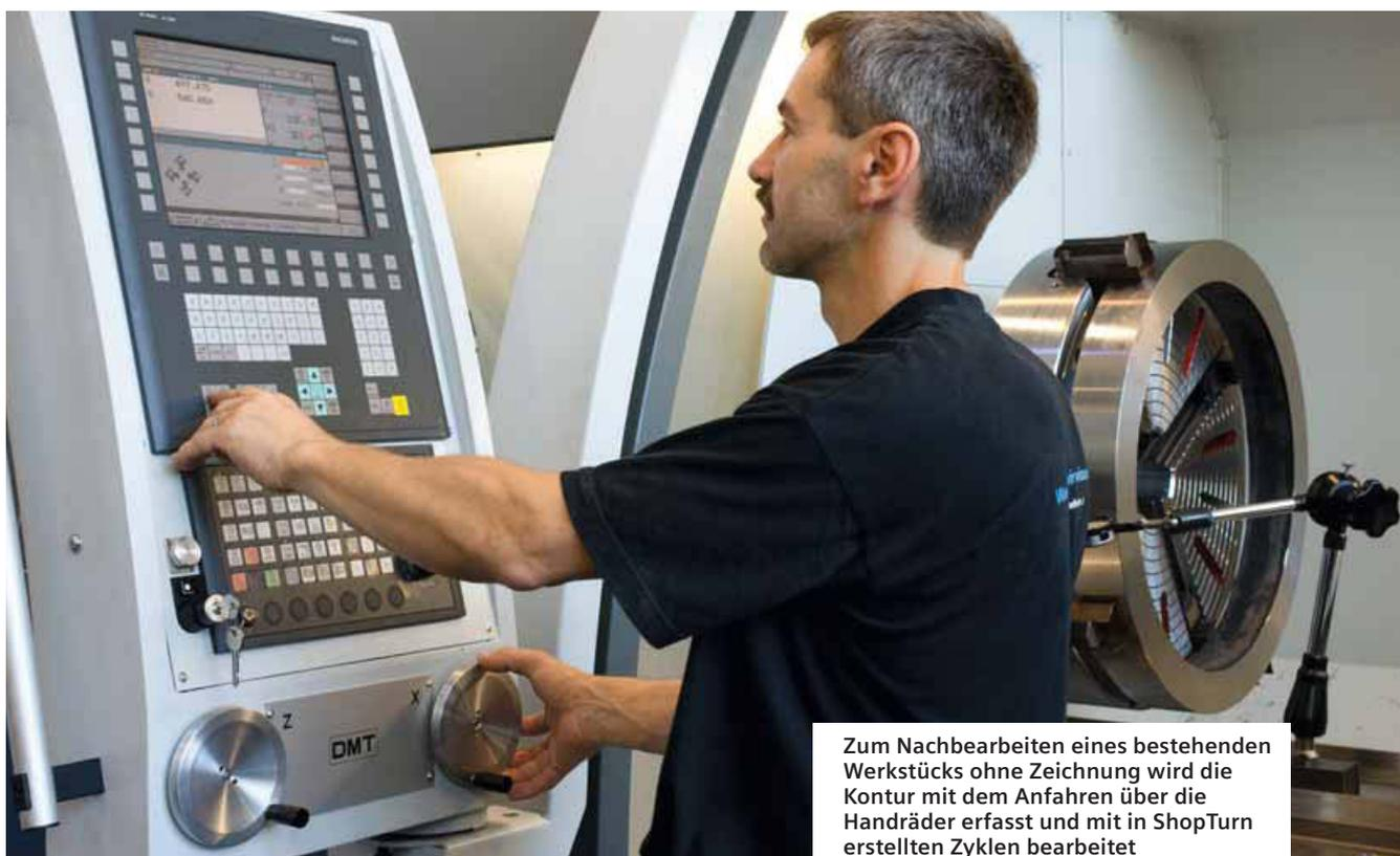
Zum Nachbearbeiten eines bestehenden Werkstücks ohne Zeichnung wird die Kontur mit dem Anfahren über die Handräder erfasst und mit in ShopTurn erstellten Zyklen bearbeitet
